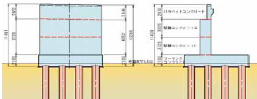
図-2.1 A2 橋台コンクリート割付図
